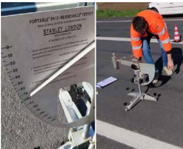
Prove di aderenza con Skid Tester
